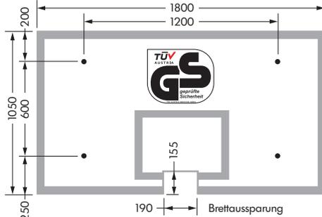
Für DIN- und FIBA-Anlage, 180 x 105 cm, 1,2 cm dick, weiße Markierung, nach DBB-/FIBA-Vorschrift. Mit rückseitig aufkaschierter Sicherheitsfolie und Glasausschnitt für Korb, Bohrungen für Befestigungen, inkl. Befestigungs-Set. GS geprüft durch TÜV AUSTRIA Nr.: 1889-PS19-086-Z.
