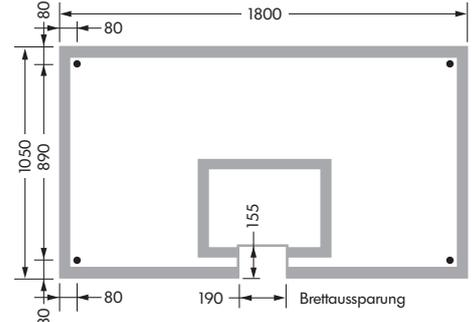
Nur für FIBA-Anlage, 180 x 105 cm, 1,2 m dick, weiße Markierung, nach DBB-/FIBA-Vorschrift. Mit rückseitig aufkaschierter Sicherheitsfolie und Glasausschnitt für Korb, Bohrungen für Befestigungen, inkl. Befestigungs-Set.
