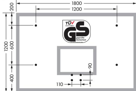
Ersatzzielbrett 180 x 120 cm, 1,2 cm dick, weiße Markierung. Mit rückseitig aufkaschierter Sicherheitsfolie und Bohrungen für Befestigungen von Brett und Korb inkl. Befestigungs-Set. GS geprüft durch TÜV AUSTRIA Nr.: 1889-PS19-086-Z.
