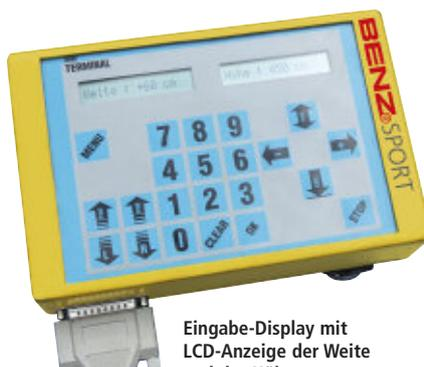
Eingabe-Display mit LCD-Anzeige der Weite und der Höhe. Das Display kann in verschiedenen Sprachen konfiguriert werden.
