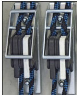
Gebrauchsstellung - die Sicherheitseinrichtung ist aktiv, unbeabsichtigtes Öffnen der Klemmhebel für Seilarretierung nicht mehr möglich.
